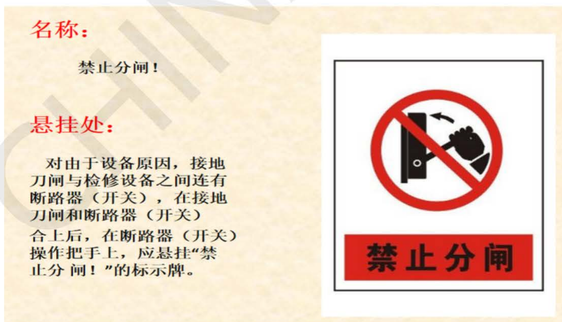
图 1.2.4 禁止分闸标示牌
